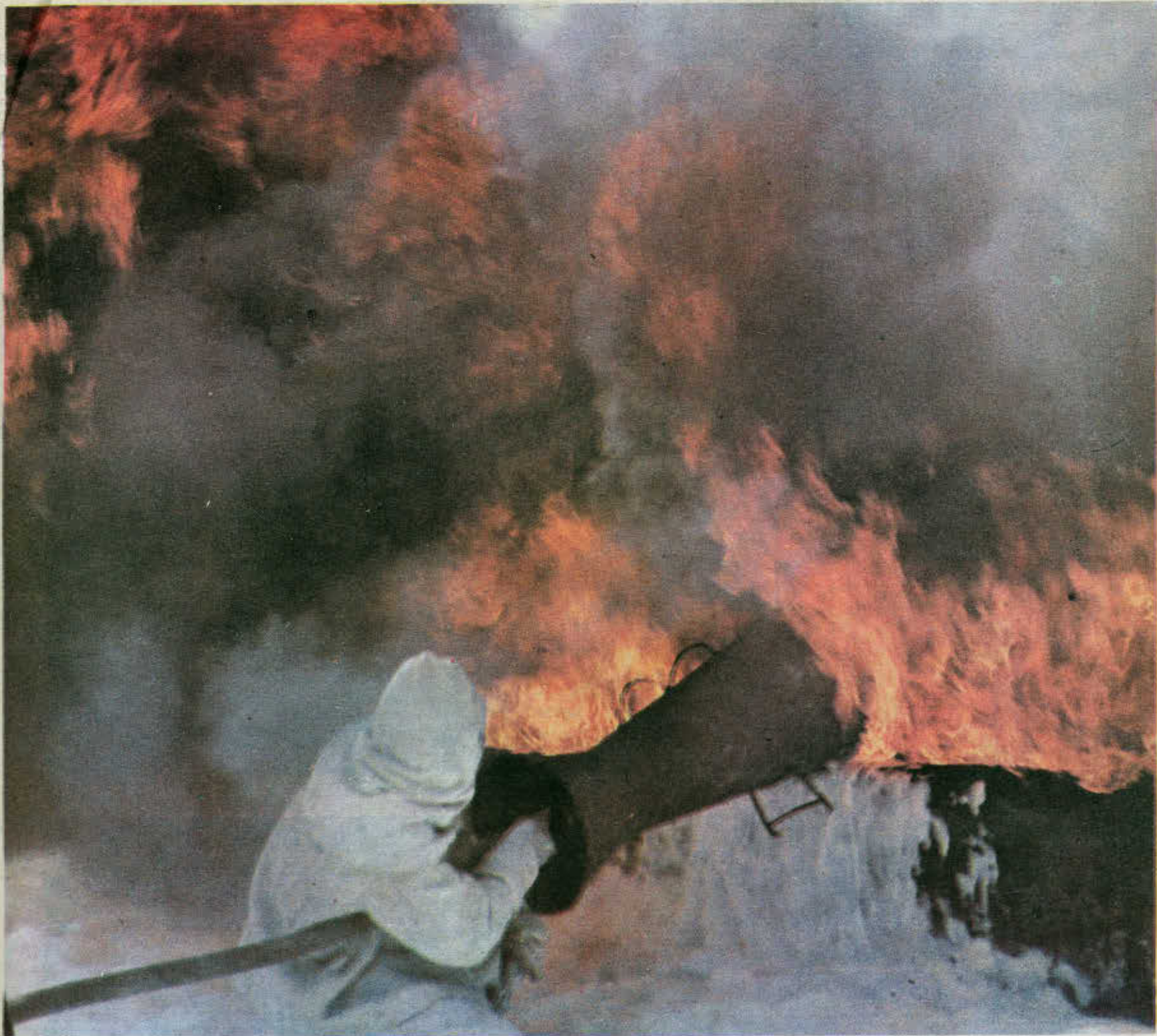
El multiplicador en acción: en pocos segundos cientos de libras de espuma brotan del aparato. En pocos segundos el fuego es dominado
