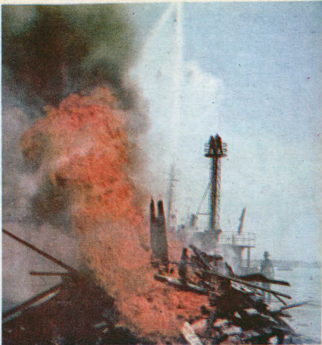
La potencia de las bombas del barco permite a los monitores (cañones) lanzar chorros de agua a gran distancia
