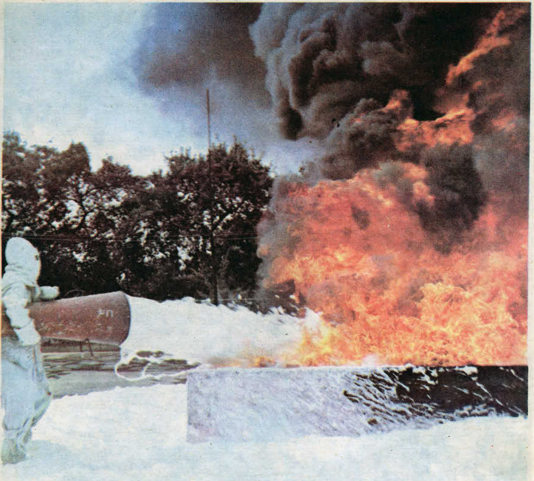
Arde el petróleo. A pesar del fuego y del calor, el bombero está obligado a permanecer estático "como una estatua" para que la espuma produzca efecto.
