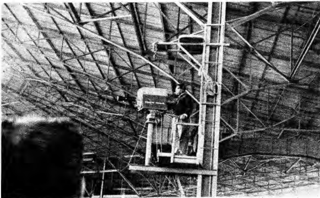
Cámara E: recoge todo el terreno; usa lentes de 25 pulgadas y 135 milímetros.
