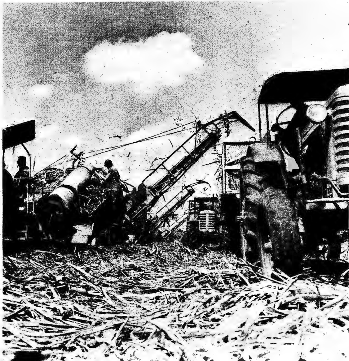
Velocidad de trabajo de la combinada: cerca de dos kilómetros por hora. En 10 horas, 245 toneladas de caña
