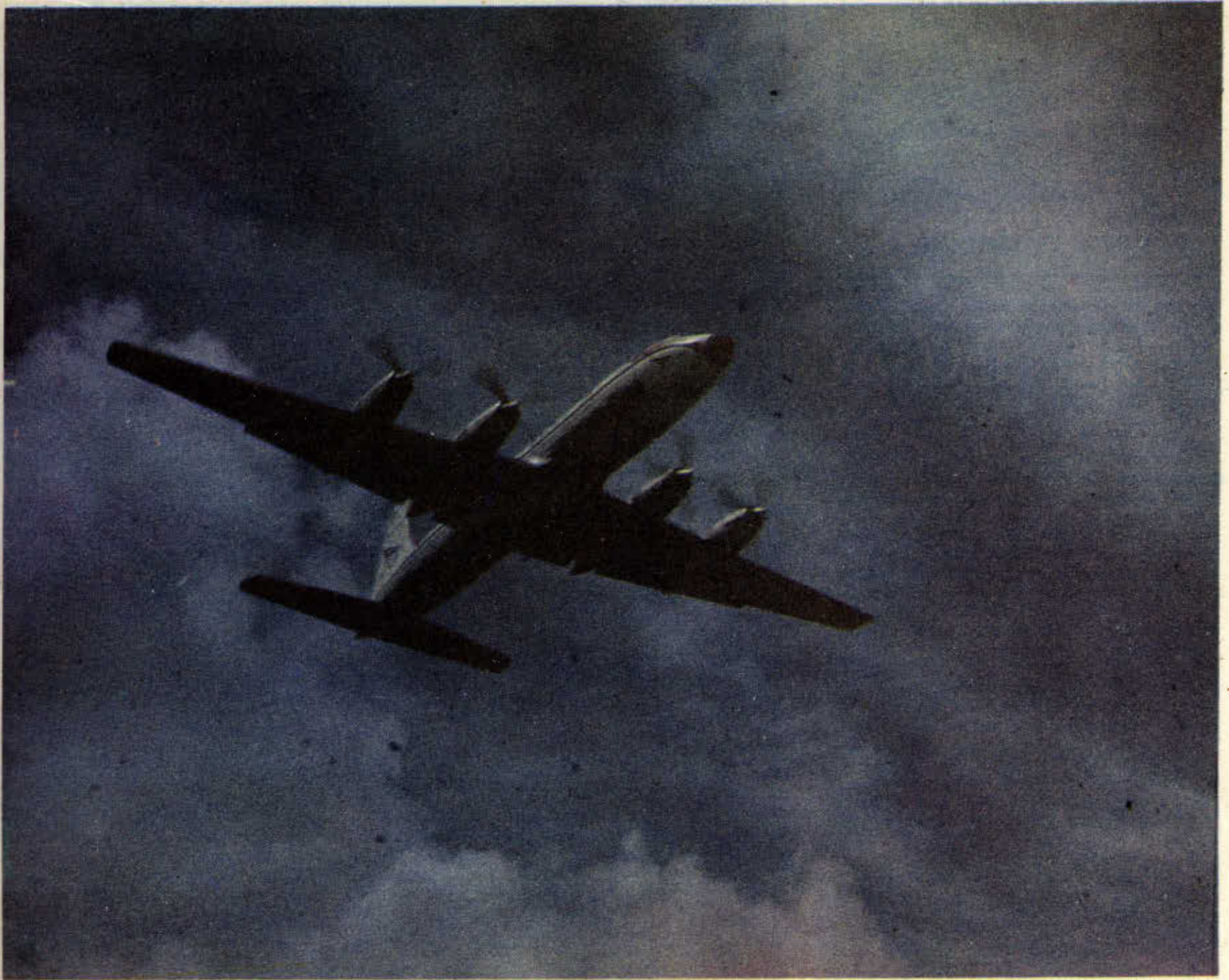
Su nombre es Britannia BB-318: cuando despegá, trepa por el aire a una velocidad de 6.2 metros por segundo y acelerando. Tiene cuatro motores pero puede volar con tres o dos
