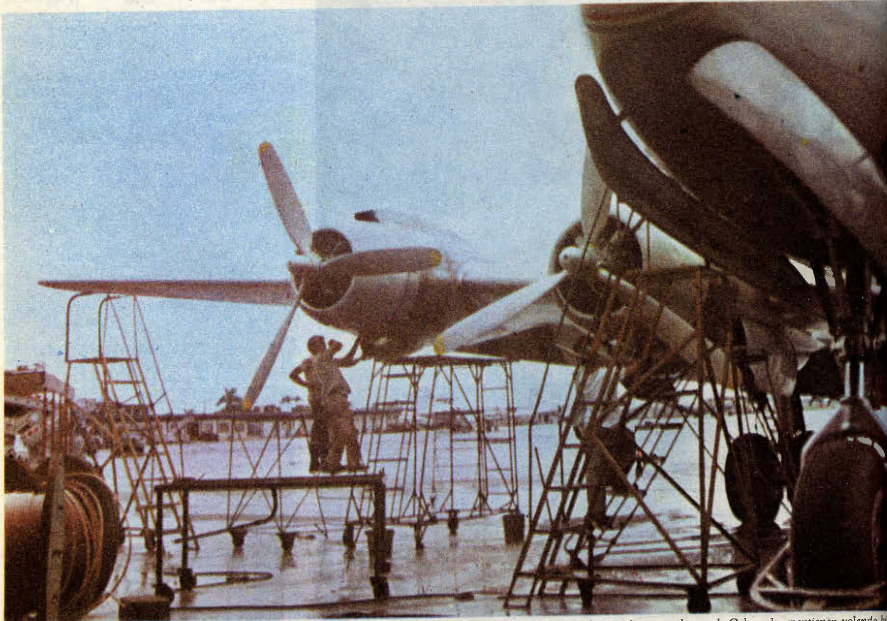
Un DC-4 cumplió 25 horas de vuelo y los manuales indican que hay que darle un servicio. Fabricados en Estados Unidos los técnicos y obreros de Cubana los mantienen volando bien
