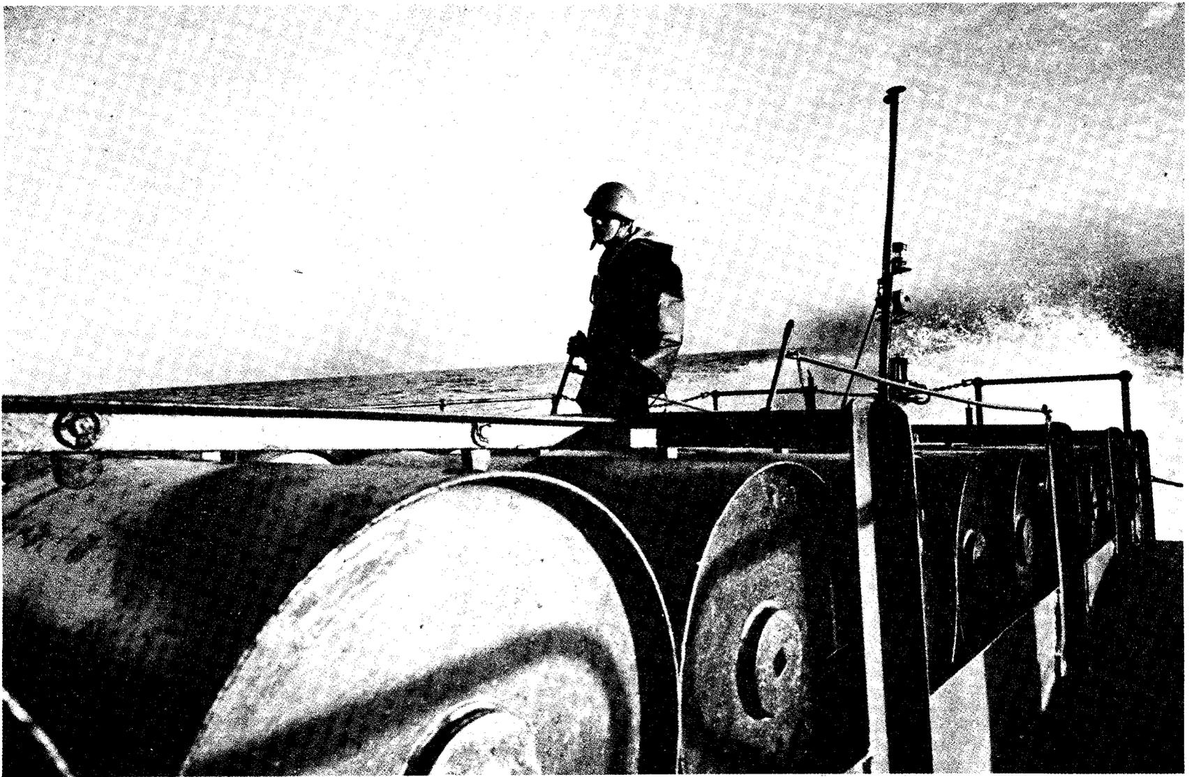
A LA ORDEN DE ¡FUEGO! SE LANZAN LAS BOMBAS DE PROFUNDIDAD ACCIONANDO UNA PALANCA
