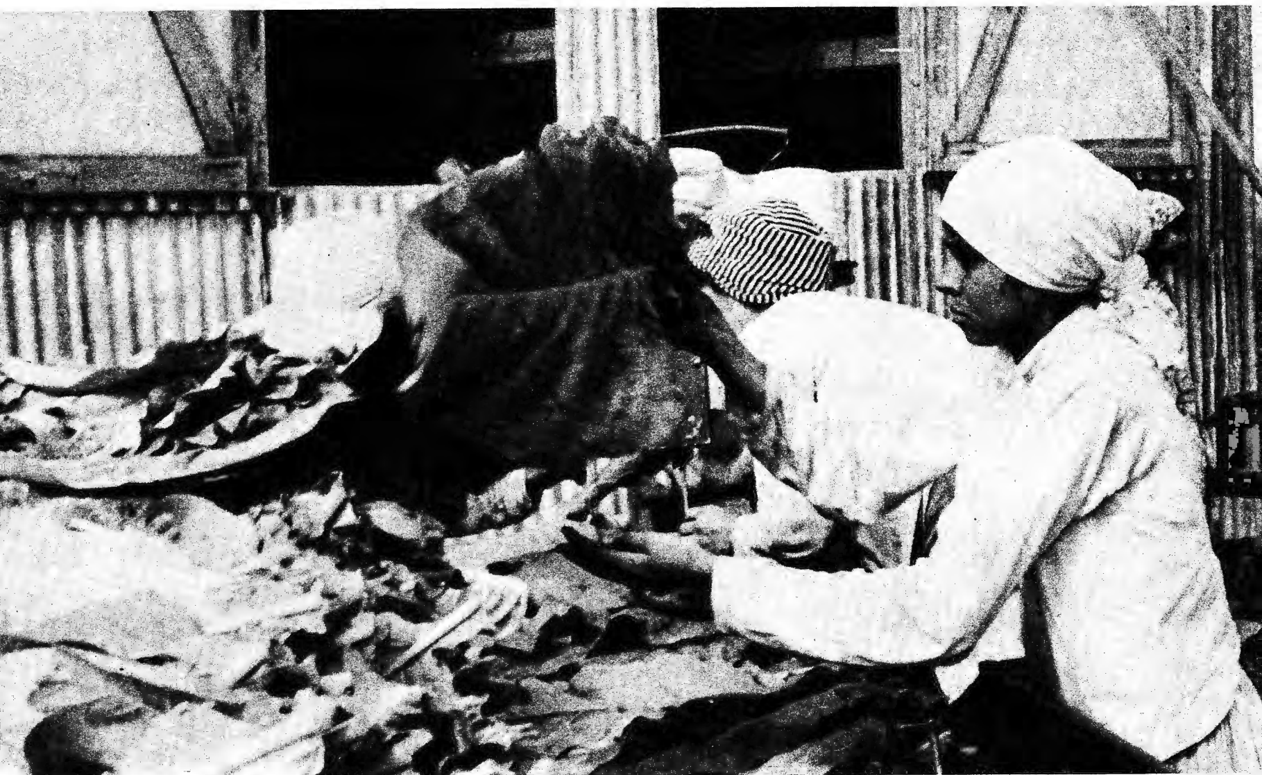
DIESTRAS OPERARIAS UNEN LAS HOJAS DE TABACO ENTRE SI, USANDO UN ENSARTADOR AUTOMATICO. LUEGO LAS ENVIAN A LA "CASA DE CURAR" DONDE SERAN SOMETIDAS AL CALOR
