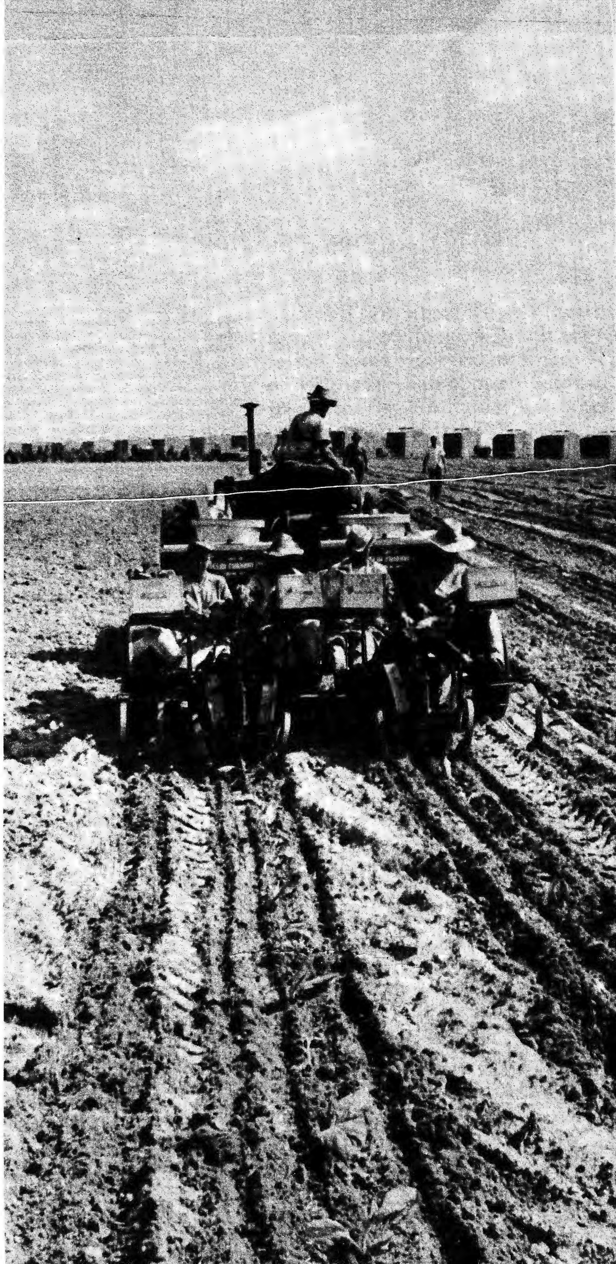
LA MAQUINA PLANTADORA. UNA MARAVILLA QUE EN UN SOLO DIA SITUA 60 MIL "POSTURAS", LAS ABONA Y RIEGA EN UN PAR DE SEGUNDOS. PARA REALIZAR ANTES EL MISMO TRABAJO QUIEBRA-CINTURAS, SE NECESITABA MEDIO CENTENAR DE HOMBRES
