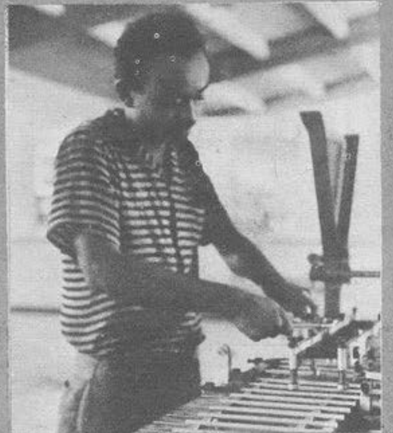
Aquí, encasquillado y colocación de gomas
