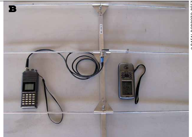
FIGURA 18. A. Colocación de un radiotransmisor en una rata negra, Isla Isabel, Golfo de California, México. B. Equipamiento utilizado en radiotelemetría: antena, receptor y GPS.
